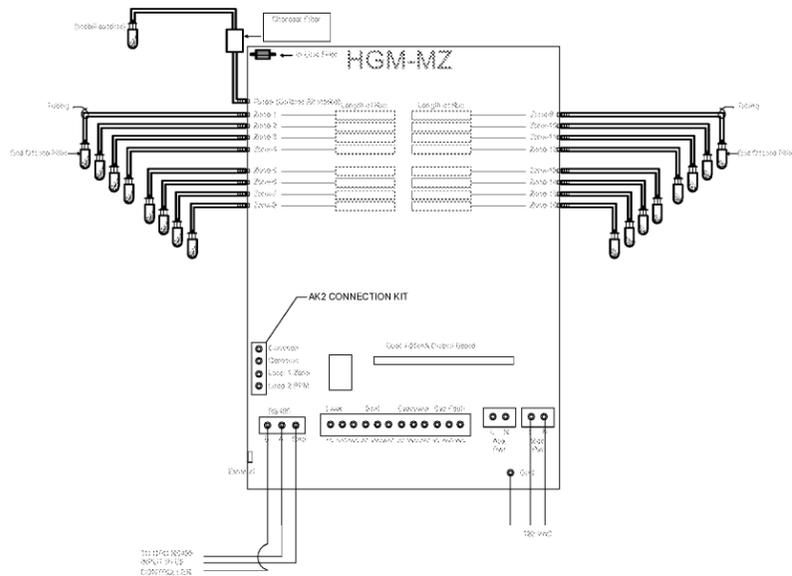
1 REFRIGERANT LEAK DETECTION UNIT - HGM MZ
