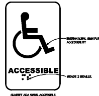
3 ADA FITTING ROOM SIGNAGE A-1.2 SCALE: N.T.S.
